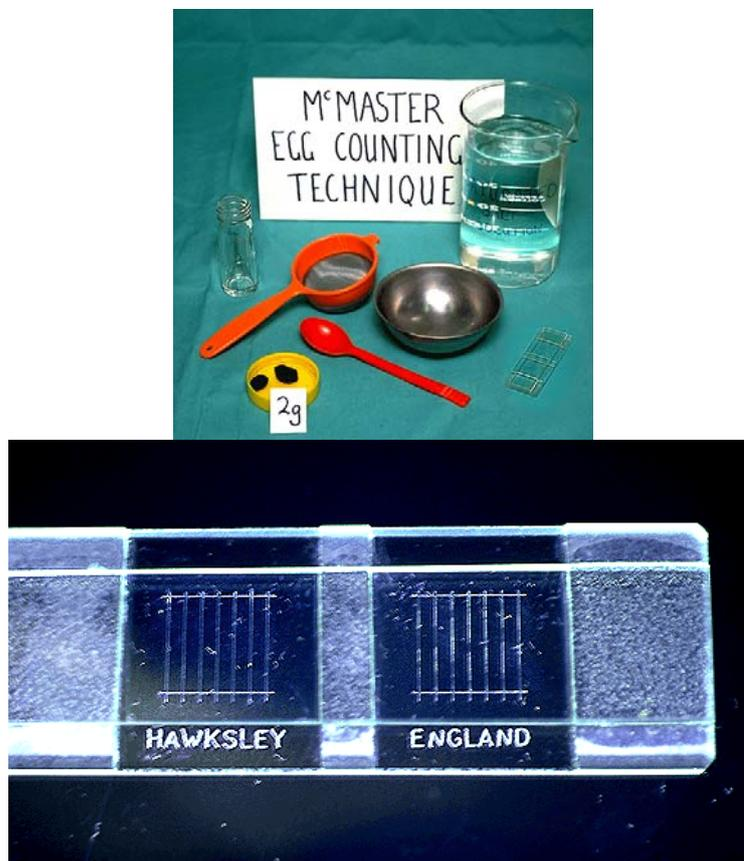
Figura 3. Acima, material necessário para realização do teste de McMaster. Abaixo, a câmara de contagem que recebe o nome de Câmara de McMaster
